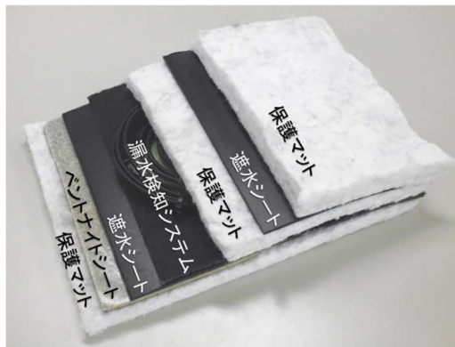
遮水工の実物写真 総厚は 3.75cm になります
